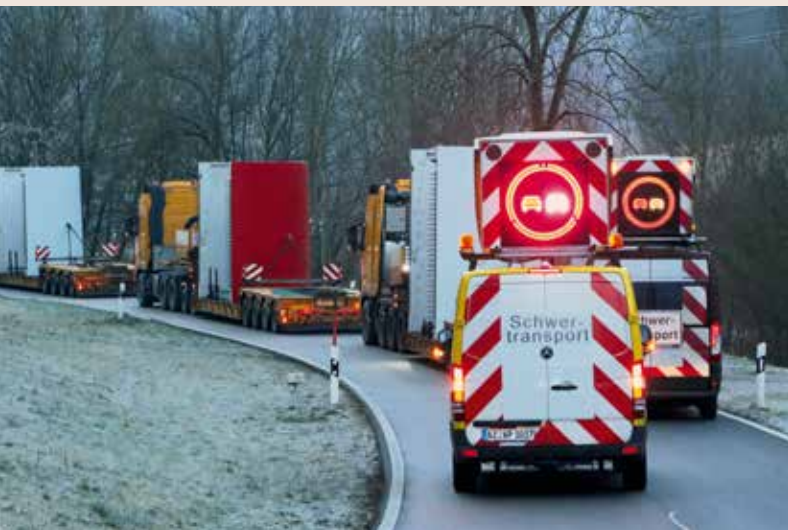
Kolonnenfahrt: Die Halbschalen sowie die Stahlturmschüsse rollen an.
